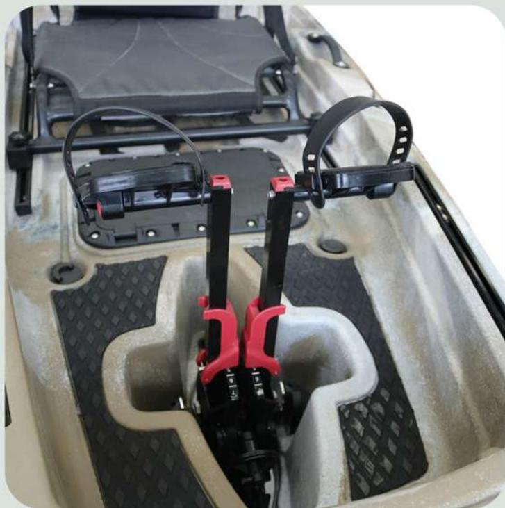
**ATTENTION, vérifiez avant chaque utilisation du canoë le serrage de toute la visserie et des attaches afin de ne pas endommager votre canoë et plus particulièrement la visserie du système d'attache du pédalier car ce dernier est soumis à des contraintes mécaniques importantes.**
