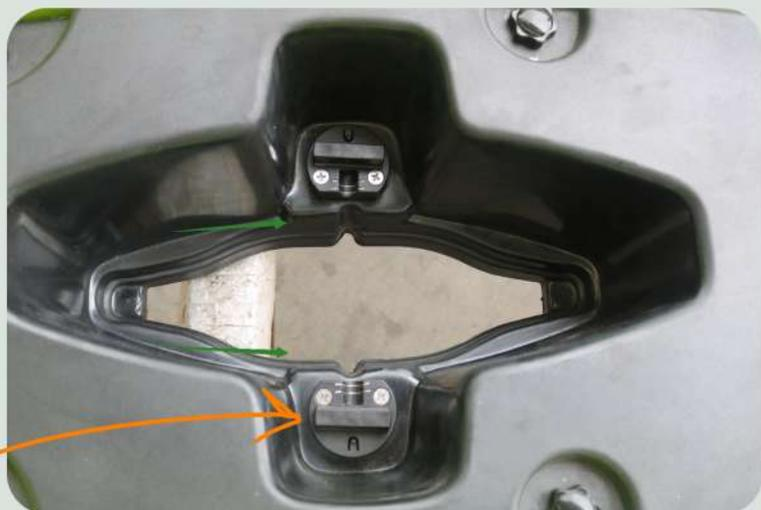
Le système d'installation du pédalier est simple et rapide. Pour installer ou enlever votre pédalier (par exemple lorsqu'il y a des hauts-fonds ou lorsque vous approchez de la bordure), il suffit de pivoter les systèmes de verrouillage et d'insérer ou enlever votre pédalier.
