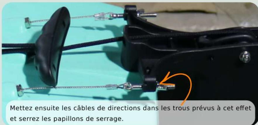
Mettez ensuite les câbles de directions dans les trous prévus à cet effet et serrez les papillons de serrage.
